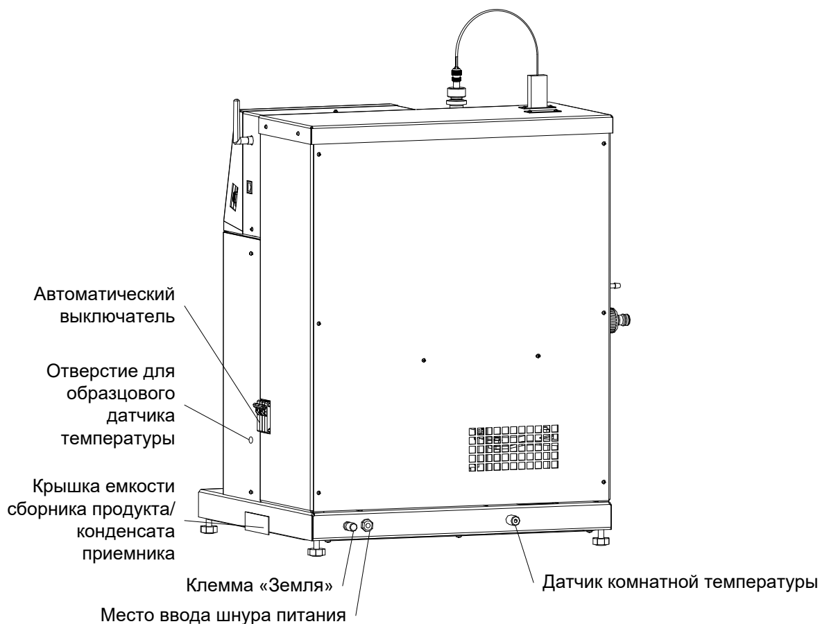
Рисунок 2 – Вид аппарата сзади
